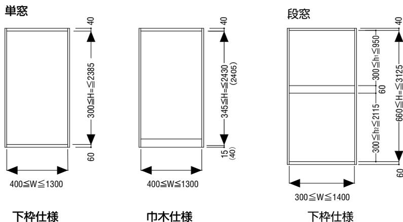
( ) は非防火の自動ドアと防火連結材を使用した連窓の場合
