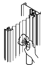
スプレー吹き付け
