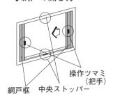
①サッシの内観右(左)端に収納されている網戸を操作ラベルにしたがって 把手をもって引き出します。
