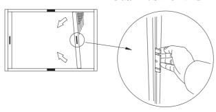
網戸の開放は必ず網戸框の中央部についている操作ツマミ(把手)を図のように操作してください。その他の部分を持って操作すると網戸の動きが不安定になり作動不良となる場合があります。また、正常操作時でもゴミや力の掛け方により不安定な作動となる場合があります。網戸の動きが不安定になると網が収納されない場合がありますが、本書のP.44に収納方法が記載されています。
