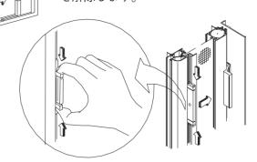
④ロックを解除し、スライドバーを閉鎖 方向に少しずらし、バーから手を放し ます。手を放す位置や、指はさみ防止 のための作動スピードコントロールに より、網が閉まりきらない場合は手で 押して閉鎖してください。
