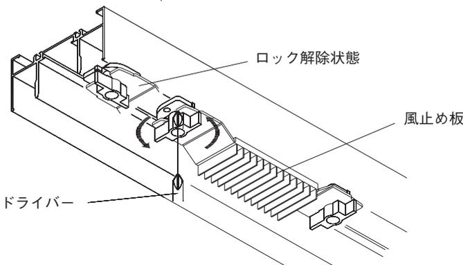
※障子を清掃などで取り外すときは、風止め板と前記のはずれ止めを縦枠側にずらしてから取り外してください。
