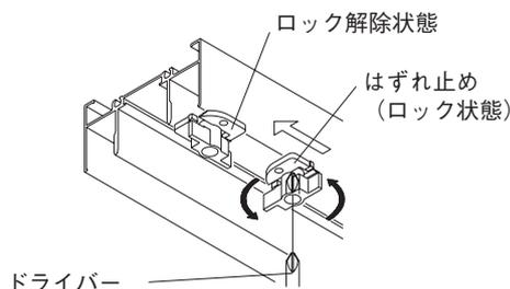
※障子を清掃などで取り外すときは、はずれ止めと次項目の風止め板を縦枠側にずらしてから取り外してください。
