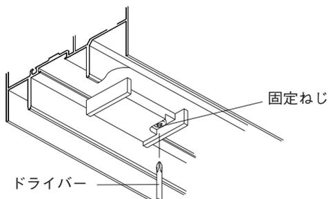
はずれ止めを移動させるには固定ねじをプラスドライバーでゆるめてから右または左に移動させてください。
