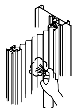
スプレー吹き付け
