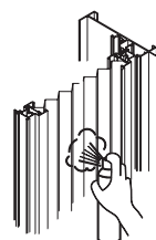
スプレー吹き付け
