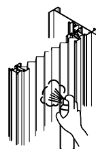
スプレー吹き付け
