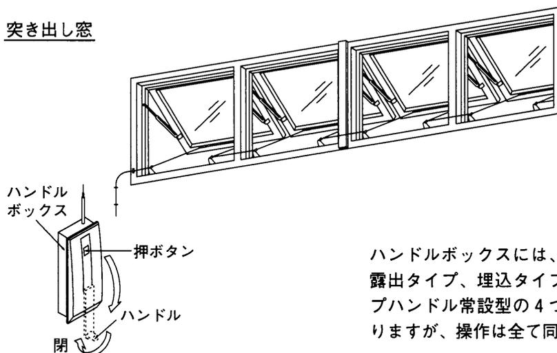
ハンドルボックスには、用途に応じて露出タイプ、埋込タイプ、埋込扉タイプハンドル常設型の4つのタイプがありますが、操作は全て同じです。
