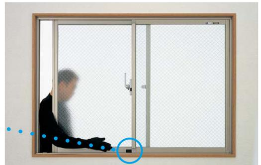
万が一、面格子が破られてもサッシの開放幅を制限できる鍵付きサブロックが付いており、開放時に解錠ボタンが召し合わせ部に隠れ、外部からの不正解錠を防ぎます。
