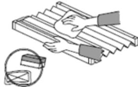
4. 網の清掃後、網を元の状態に取り付け直してください。
