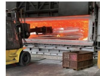
溶解炉へアルミリサイクル材投入
