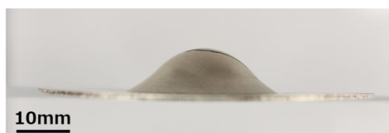
図3 ZA系新合金圧延材の室温エリクセン試験結果
