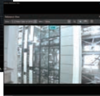
耐震性試験ではフレームやガラスの層間変位追従性を可視化
