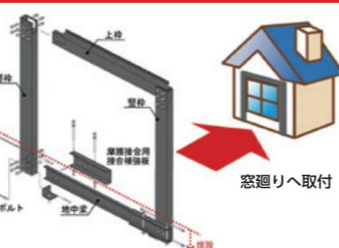
アルミニウム合金耐震補強枠
