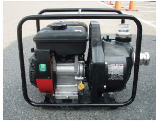
エンジンポンプ 吐出量：500～600L/min程度
